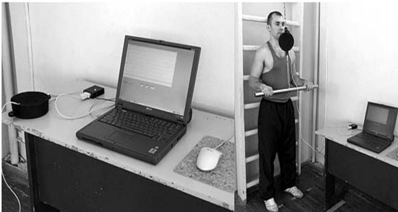
14.7-rasm. Tenzodinometriya. Tajriba natijalari kompyuterga kelib tushadi.
