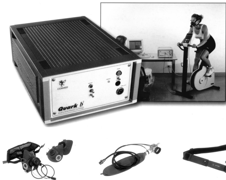
Рис. 7.54. Система “Quark b 2 ” прямого определения потребления кислорода и других метаболических показателей при велоэргометрической нагрузке
