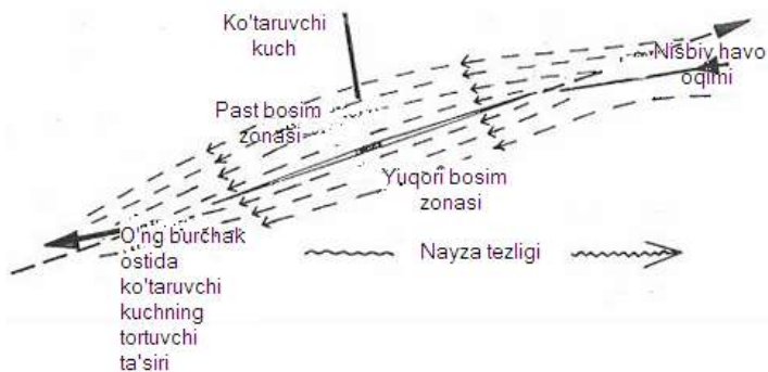
75-rasm. Havo muhitida nayzaning aerodinamik xossalari ta’sir ko‘rsatuvchi asosiy kuchlar
